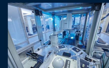
Jede Platine mit RGB-LED wird einzeln vermessen und abhängig vom vorgesehenen Verwendungszweck kalibriert. Dabei werden elektronische und optische Eigenschaften der LED erfasst und ein Farbabgleich durchgeführt. Diese Daten und die hieraus resultierenden individuellen Parameter für das Modul werden auf dem Mikrocontroller gespeichert.
